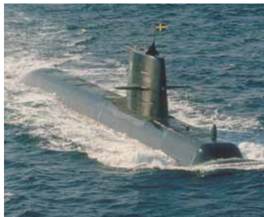
Ubåtarna i Gotland-klassen är de första ubåtarna som från början försetts med det luftberoende Stirling-maskineriet. FBB, FOTO: KOCKUMS
