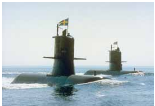
Två ubåtar av typ Västergötland, levererade i slutet av 1980-talet. Två av fyra skall förses med det luftberoende Stirlingmaskineriet, varför typen benämns Södermanland.
