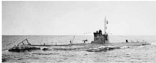
Ubåten Uttern av Bävern-klass var en tysk utveckling av franska Labeuf-typen och konstruerad av varvet A.G. Weser i Bremen. De beställdes 1916 men kom i tjänst först efter första världskrigets slut och fick en 20-årig tjänstgöringstid – ett gott betyg!
