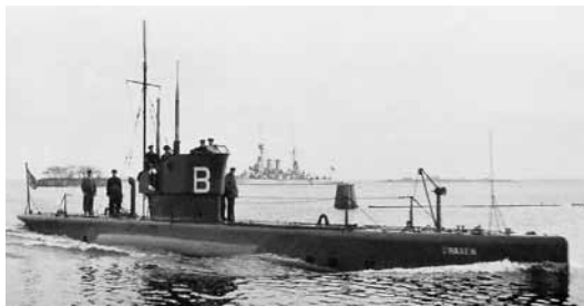
Ubåten Braxen var anpassad för färd på Göta kanal och medförde fyra 45 cm torpeder. Här under prov med radioutrustning, och i bakgrunden ett pansarskepp av Åran-typ.
